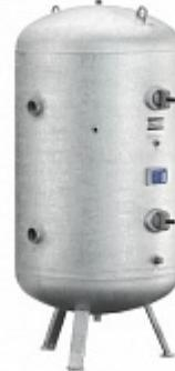
Воздушный ресивер Atlas Copco LV 521 объёмом 475 литров можно устанавливать после компрессоров, которые подают сжатый воздух при давлении не более 21 бар. Как правило, этот воздухосборник устанавливают после поршневых или винтовых компрессорных установок. Ресивер LV 521 не попадает под обязательную регистрацию в Ростехнадзоре.
