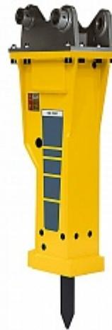
Гидромолоты среднего класса являются чрезвычайно эффективным оборудованием. Молоты Epiroc MB 1650 приводятся в действие с помощью масла и газа, что уменьшает их зависимость от гидравлической системы. 70% энергии удара образуется газом в поршневой камере и только 30% – маслом гидравлической системы носителя. Поступающая энергия оптимизируется и усиливается с помощью внутреннего регулирующего клапана.
