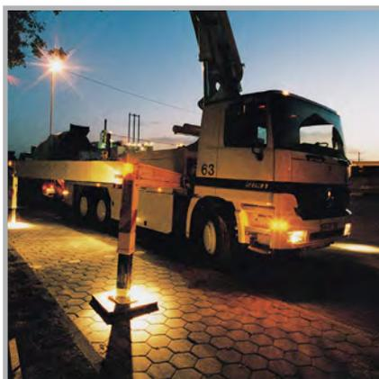
Фонари для освещения 4 выдвигаемых опор повышают безопасность и скорость развертывания оборудования в темноте.
