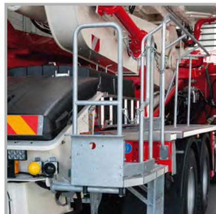
Эргономичная рабочая платформа (опция) с противоскользящим настилом обеспечивает удобное пространство для работы оператора.
