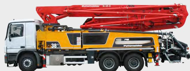
Вес- до 25 тонн: Допускается для проезда по дорогам общего пользования РФ, не требуется получение специального разрешения.
