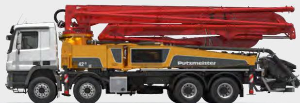
Вес - до 30 тонн: Допускается для проезда по дорогам общего пользования РФ, не требуется получение специального разрешения.
